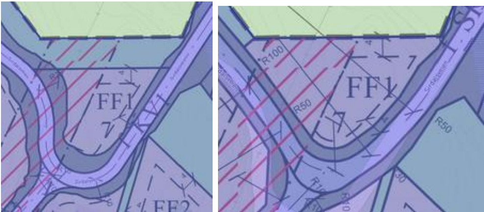
Figur 6: FF1 er utvidet mot nord siden svingen på veien er flyttet litt mot nord
